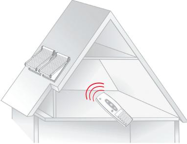
**i** Die Anzahl der mit einem Handsender gleichzeitig bedienbaren Beschattungen ist nur durch die Reichweite (im Haus ca. 25m) limitiert. Es können alle in Reichweite befindlichen Beschattungen gleichzeitig mit einem Handsender bedient werden.
